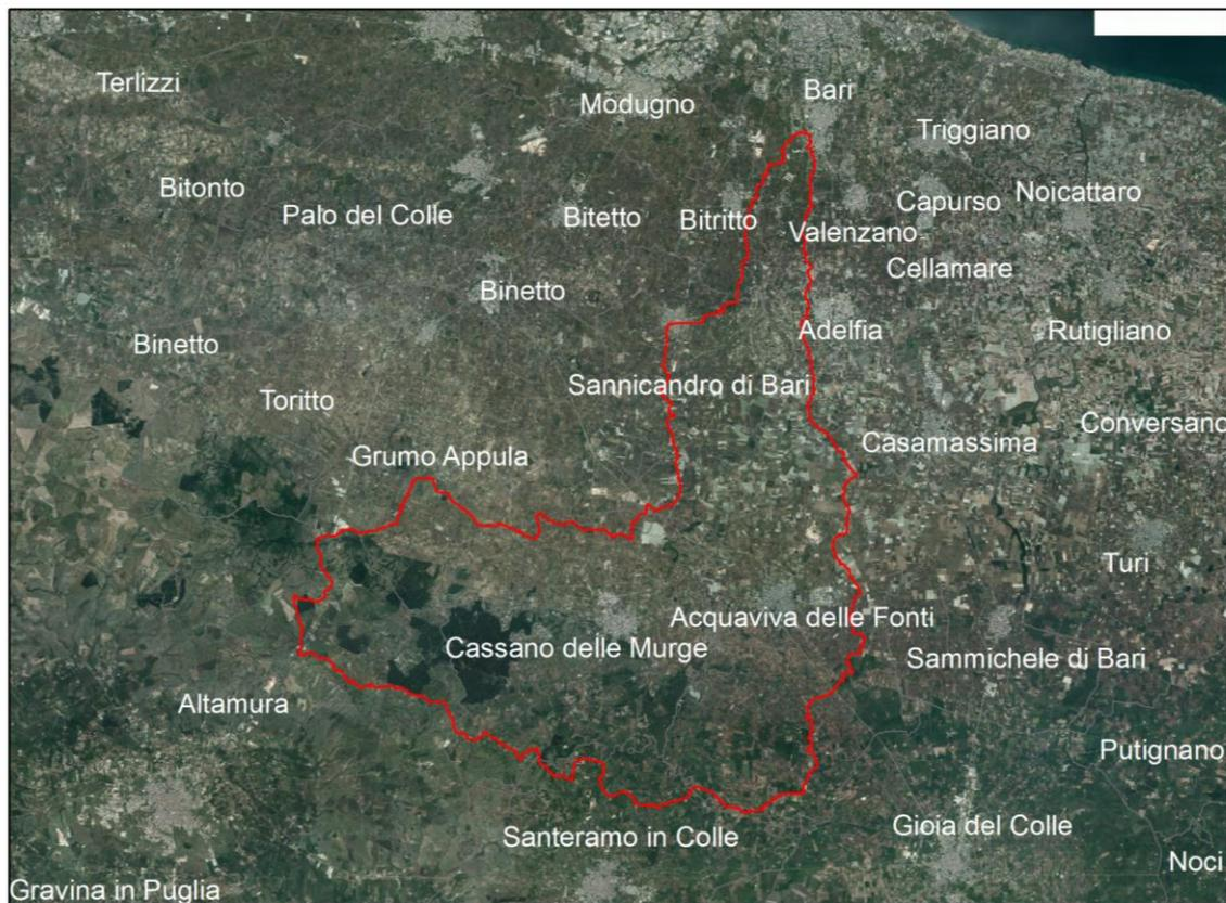
Il bacino del Picone ha una superficie di circa 292 km<sup>2</sup> (alla foce), di circa 285 km<sup>2</sup> all'imbocco del canale deviatore a Carbonara. Si compone di due rami che si uniscono a Carbonara: il Badessa a sinistra (nasce a ovest di Cassano), il Baronale a destra (nasce presso Acquaviva).
